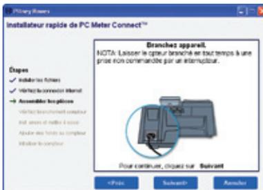
Branchez une extrémité du cordon d'alimentation dans la prise située au dos du compteur, comme illustré, et l'autre extrémité dans une prise située à proximité qui n'est **pas commandée par un interrupteur mural ni un limiteur de surtension**.
