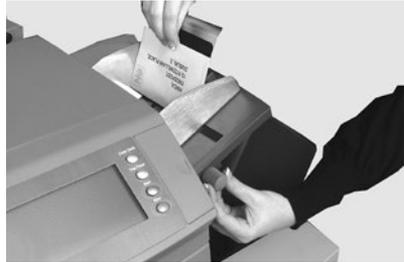
2. Beachten Sie die Markierung an der Beilagenzuführung, und richten Sie den Beilagentyp am entsprechenden Symbol (DL-Kuverts A bis D) aus.
