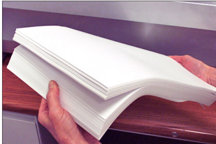
Figura 3.2: Solte o material (ventilador)
