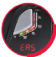
Através de um simples toque no botão é possível visualizar nos LEDs e no Display as informações de tensão de entrada, de saída, de potência instalada e de nível de baterias. É possível também visualizar eventos críticos e ocorrências tais como o envelhecimento das baterias, erros de operação, etc.
