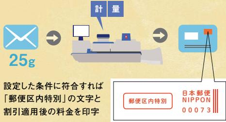
設定した条件に符合すれば「郵便区内特別」の文字と割引適用後の料金を印字
