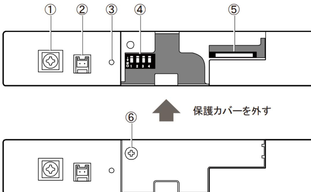
2. ⑤の挿入されている SIM カードを押すと SIM カードが手前に少し出てきますので、SIM カードを抜いて下さい。
