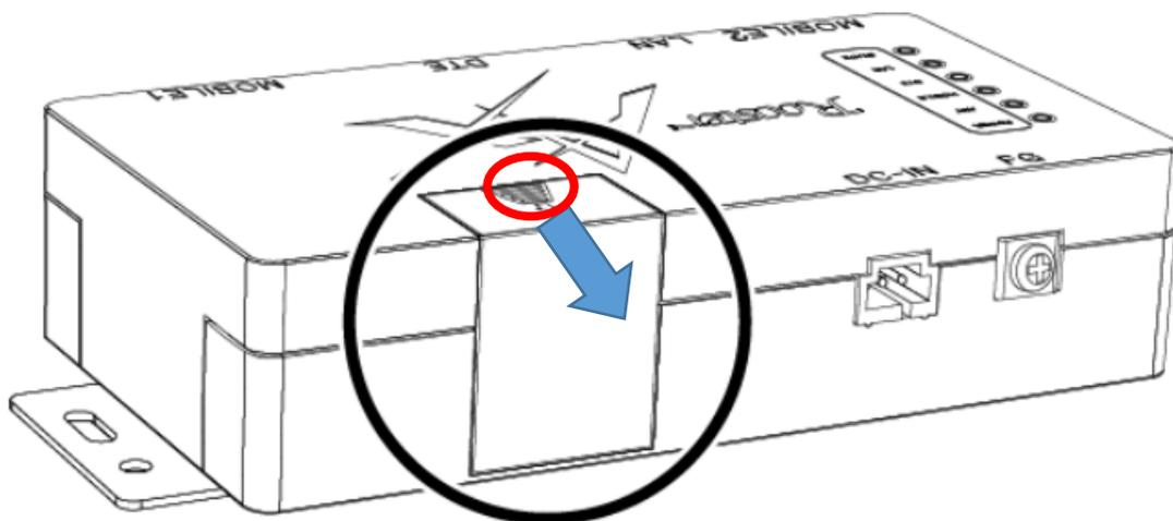
赤丸の部分に指をあて下へ押しながら矢印方向に引くとカバーが外れます。
