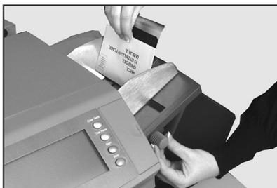
2. インサートフィーダーに貼ってあるラベルを参照します。インサートを図と比べます。インサートフィーダーの青いレバー（番号 1～9）およびセパレータシールド（アルファベット A～D）の設定を見ます。
