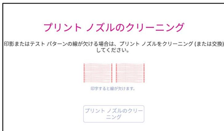
4. クリーニングが完了すると、テストパターンを印刷するか質問されます。テストパターンの印刷を実施して、正常に印刷されない場合、インクカートリッジを交換またはプリントヘッドを清掃する必要があります。
