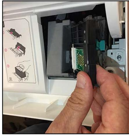
4. プリントヘッドの表面を乾いた糸くずのない布で、傷をつけないように清掃します。
