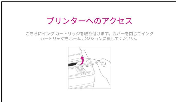
4. カートリッジホルダーが手前に移動します。以下の画面左のラベルに記載されているようにインクカートリッジを取り外します。
