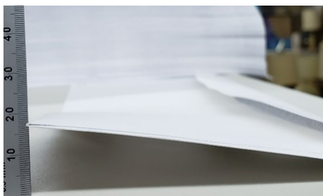
カールまたはねじれ - 下側角の引き込みをスペーサーにより調整する
