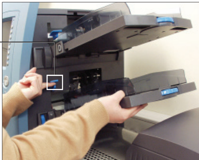
図 3.1.1：セパレーターを持ち上げてトレイをトレイ台に入れる
