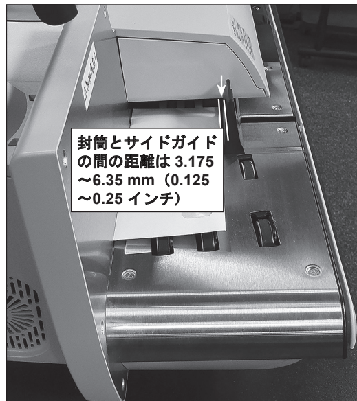
図 7.16 : 封筒とサイドガイドの間の距離
