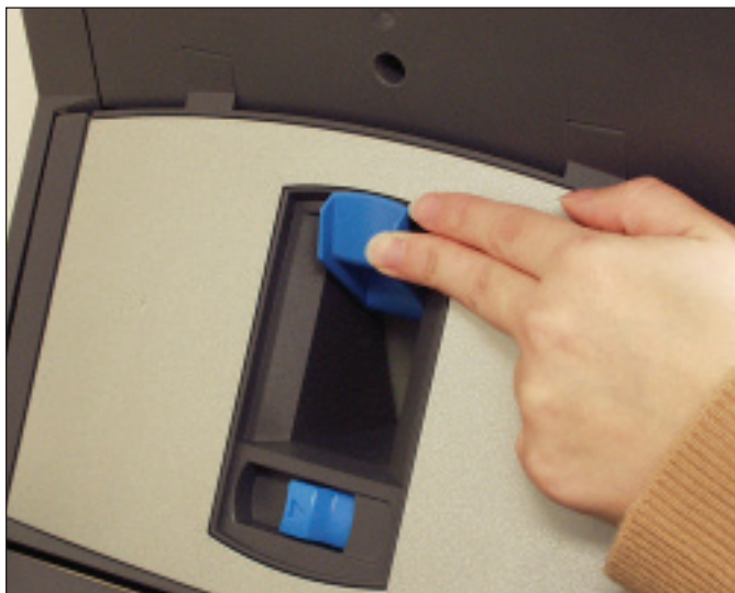
図 3.8.1 : セパレーターギャップレバーを押し上げる
