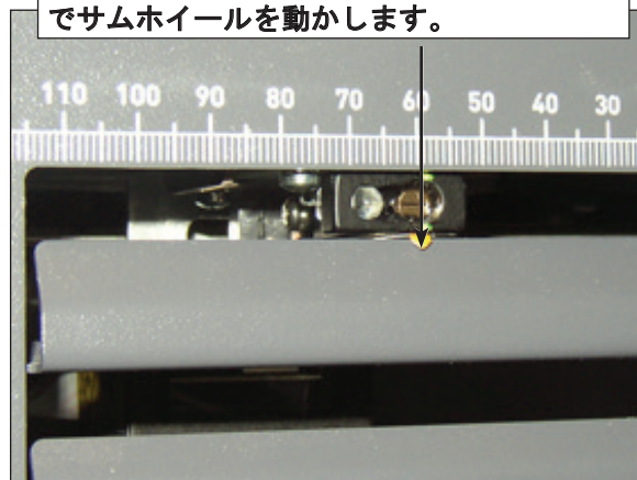
図 8.4 : ポインターを使用して正しいスキャンヘッド位置を確認する
