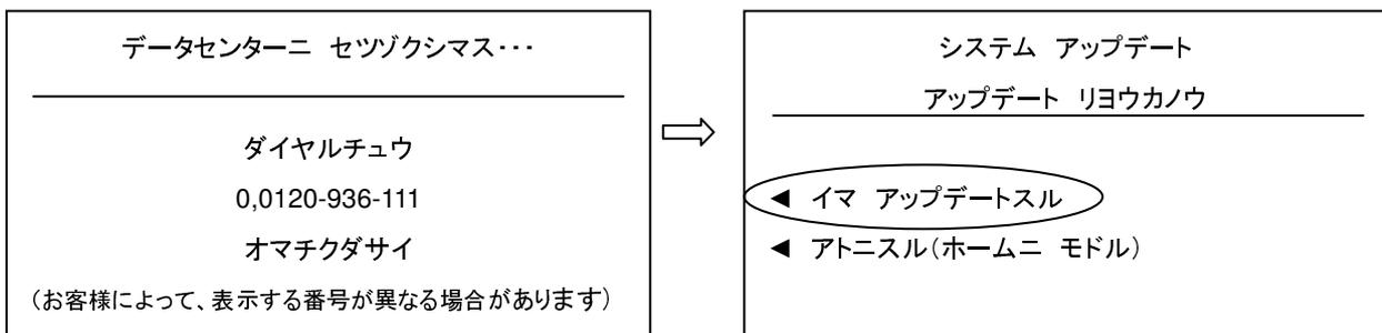
3. ダウンロードが開始されます。画面に進行状況が表示されますが、所要時間はお客様の環境により異なります。ダウンロードが完了すると確認画面が表示されますので、「ホームニモデル」を選択してください。
