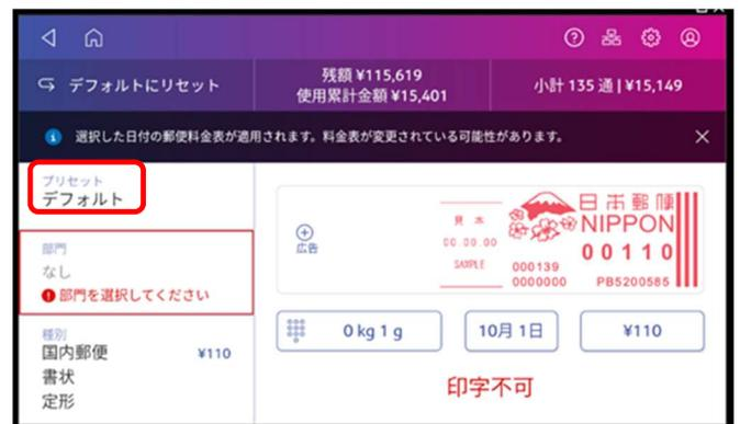
1-2 プリセット画面が表示後、確認したいプリセットをタップすると設定が表示されます。プリセット設定内に「郵便料金手入力」と設定されているプリセットは、郵便料金を直接手入力でプリセットに料金設定しているため確認が必要です。
