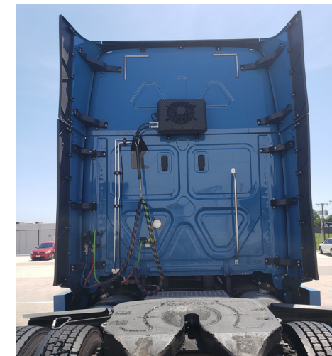
Cabine de camion avec groupe électrogène auxiliaire pour réduire les émissions à l'arrêt.
