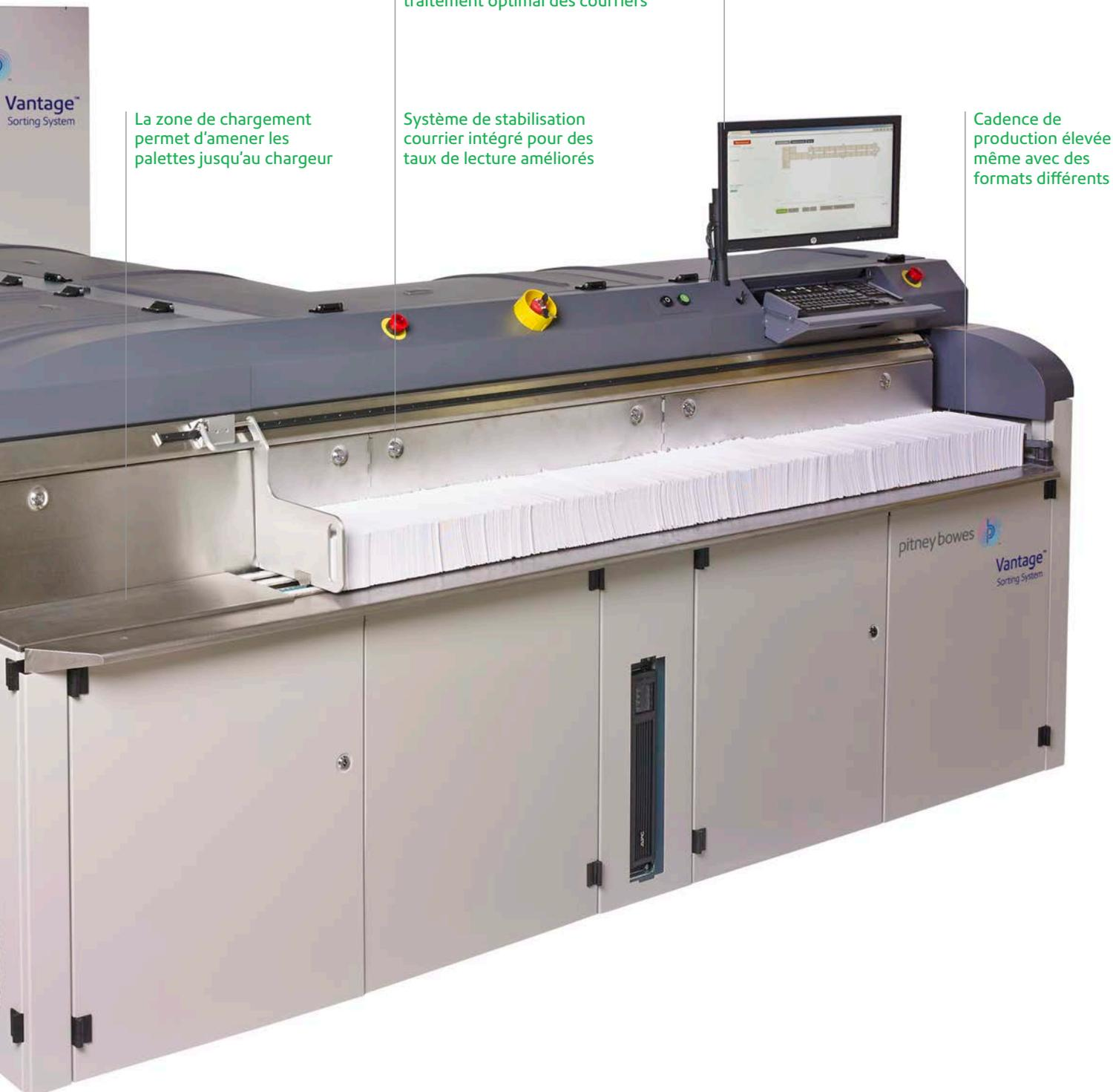
La zone de chargement permet d'amener les palettes jusqu'au chargeur
