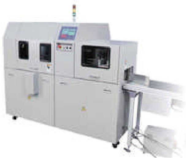
Massicot à Le massicot trilatéral **HORIZON HT110** s'intègre parfaitement dans les lignes de finition dos carré collé, pour permettre de façonner et de donner sa forme définitive aux produits imprimés (magazines, livres, catalogues...)
