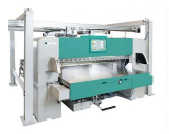
Nouveau massicot de coupe PERFECTA 225 TS pour une coupe, de précision, programmables, ergonomiques, et sécurisés. Evolutif avec des périphériques, taqueuse, élévateur, robot, etc.
