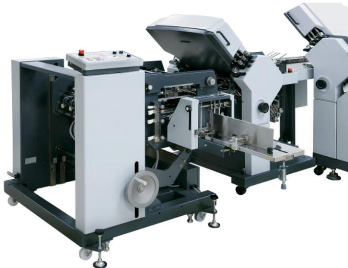
Couteau mobile KTU-40 avec réception verticale en connexion avec plieuse AF-406A et T-406A
