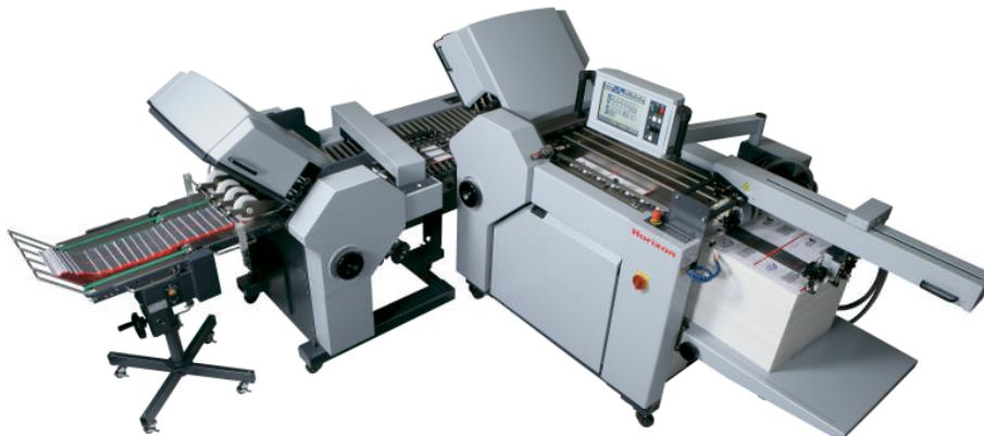
Les guides de la table de registre ainsi que les butées des poches de pliage sont automatiquement réglés par l'introduction des données de format des feuilles au panneau de contrôle tactile.
