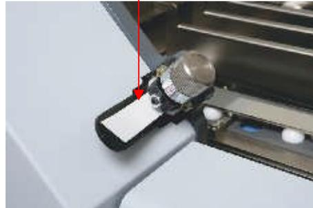
Ecran de contrôle et d'ajustement des cylindres de pliage.
