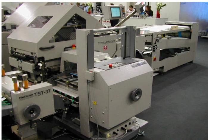
\* exemples : Couteau mobile MKU 54 avec Plieuse HORIZON AFC 546 FG
