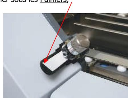
Les guides de la table de registre ainsi que les butées des couteaux de pliage sont automatiquement réglés par l'introduction des données de format des feuilles au panneau de contrôle tactile.
