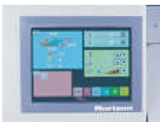
La fonction et la simplicité d'utilisation de l'écran LCD (touche screen) sont exemplaires : Il permet le pilotage et la gestion des réglages des formats de coupe, en affichant des graphiques en couleur d'une grande aisance de lecture pour l'utilisateur. Les fausses manœuvres sont ainsi éliminées grâce au guidage par menus et assistance de la procédure à suivre.
