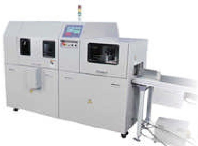
Le massicot trilatéral **HORIZON HT110** s'intègre parfaitement dans la ligne de finition **CABS 4000**, pour permettre de façonner et de donner sa forme définitive aux produits imprimés (magazines, livres, catalogues...)
