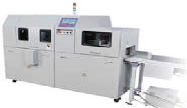
Le massicot trilatéral **HORIZON HT110** s'intègre parfaitement dans la ligne de finition **CABS 5000**, pour permettre de façonner et de donner sa forme définitive aux produits imprimés (magazines, livres, catalogues...)
