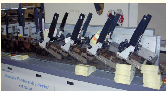
Friktions- und Rotationsanleger lassen sich bei der FPS beliebig kombinieren
