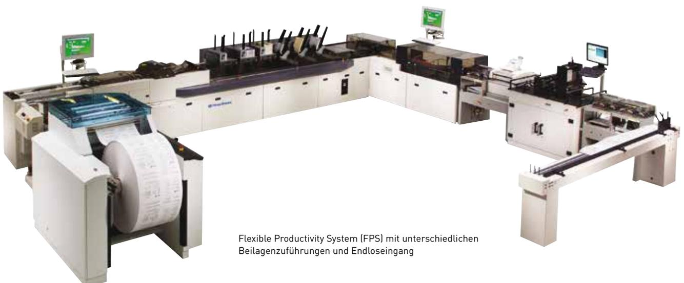
Flexible Productivity System (FPS) mit unterschiedlichen Beilagenzuführungen und Endloseingang
