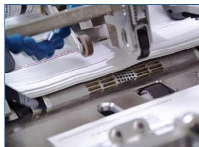
Die vakuumbasierte Trennung stellt auch bei farbigen Dokumenten eine saubere Zuführung ohne Farbabrieb sicher.
