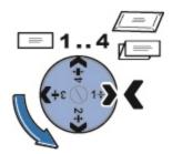
13. Guide latéral mobile situé à l'avant du plateau d'alimentation permettant de stabiliser la position des enveloppes pendant qu'elles sont alimentées dans le système. Veuillez noter que le guide latéral est une fonction en option sur les appareils Connect+ 3000 et SendPro P3000.
