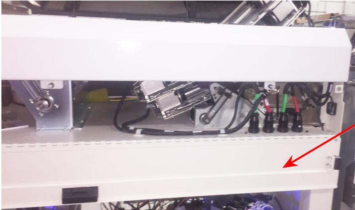
**Zugreifen auf untere Falztaschen – Abdeckung abgesenkt**
