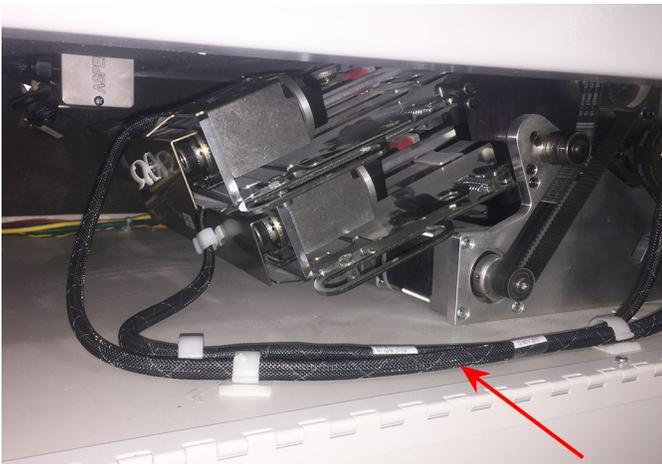
3. Ziehen Sie die automatische Falztasche 4 an den Verriegelungsgriffen heraus und anschließend wieder zurück. *(Bewegen Sie die Falztasche leicht hin und her, um die Verriegelungen an den Seiten der Falztasche von der Falzmaschine zu lösen; dadurch können Sie die Falztasche herausziehen.)*
