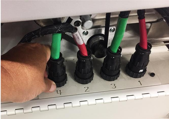
**Entfernen des Kabelbaumsteckers**
