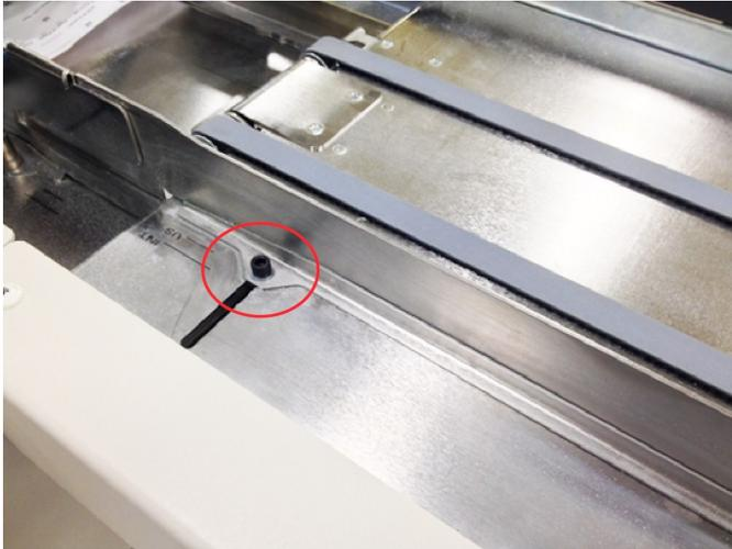
**Vis de déverrouillage du guide latéral du plateau de préalimentation (trois au total, une seule est visible sur cette photo)**
