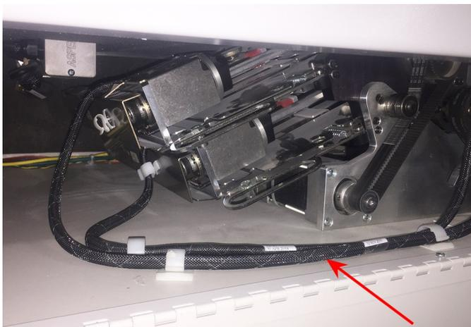
3. Retirez les poignées de verrouillage de la plieuse à poche automatique n° 4, puis tirez la plieuse vers l'arrière. (*Remuez la plieuse légèrement d'un côté à l'autre pour dégager les loquets sur les côtés de la plieuse de la machine de mise sous plis ; cela vous permet de retirer la plieuse.*)
