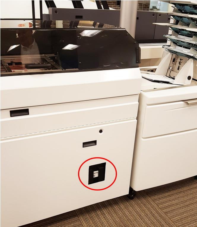
**Interrupteur d'alimentation sur l'entrée Pulse**
