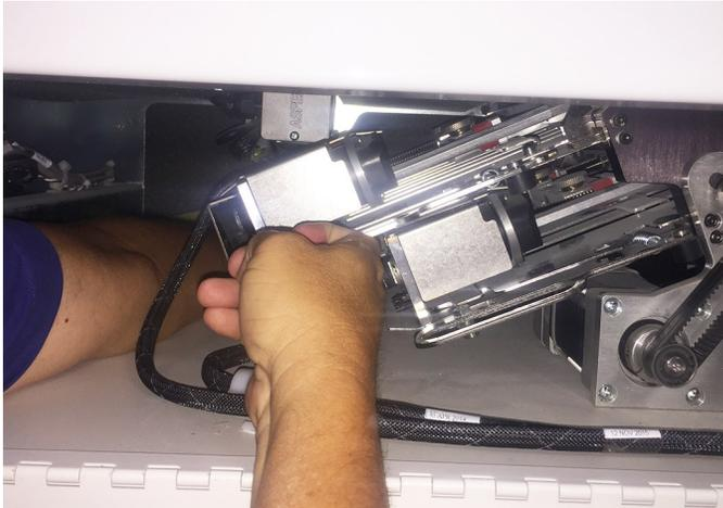
5. Déplacez la plieuse d'un côté à l'autre pour vous assurer qu'elle est bien maintenue. Si l'orifice sur le côté de la poignée du loquet est visible, la plieuse n'est pas entièrement engagée (comme dans la première image ici). Si la plieuse est installée correctement, elle doit ressembler à la deuxième image. (Ces images montrent des plieuses supérieures, mais il s'agit du même concept pour les plieuses inférieures.)
