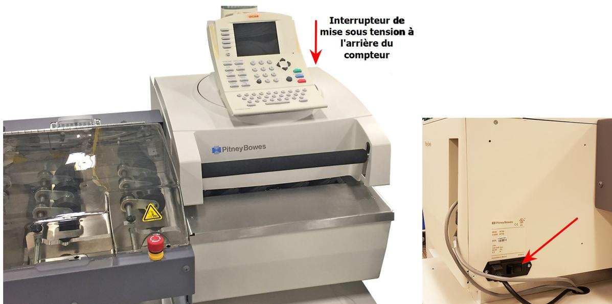
Interrupteur d'alimentation sur le compteur Infinity
