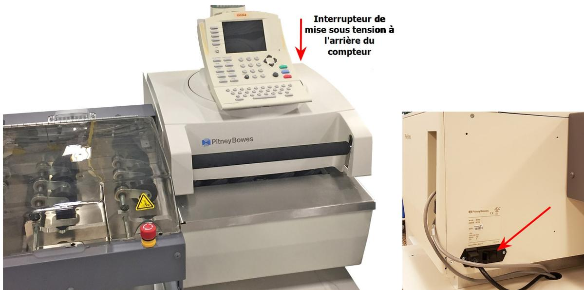
Interrupteur d'alimentation sur le compteur Infinity
