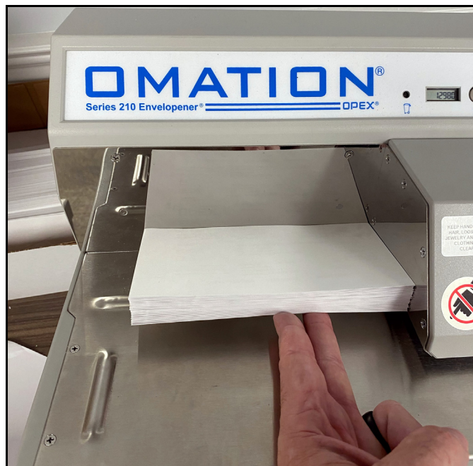
Abbildung 4-7: Beladen des Kuverteinzugfachs
