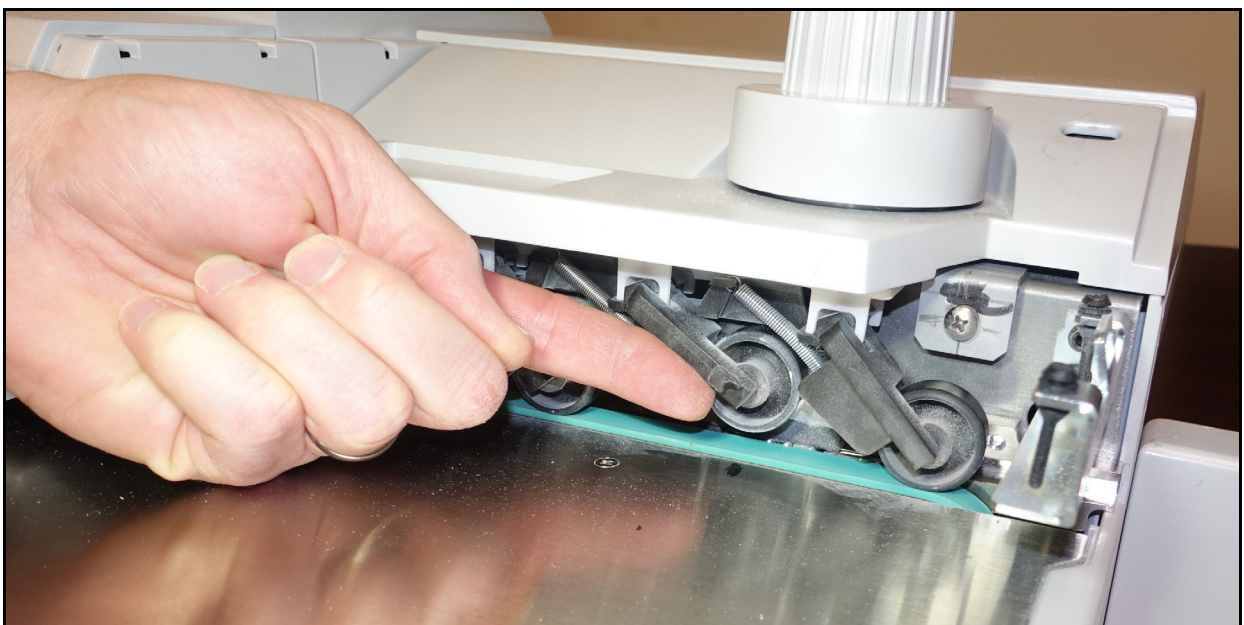
Abbildung 4-12: Reinigung unter den Walzenrollen
