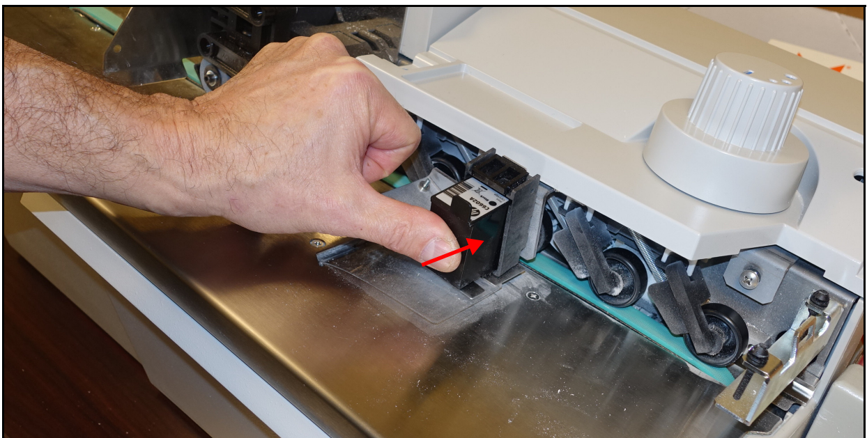
Abbildung 4-18: Austausch der Druckerpatrone
