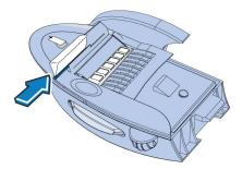
7. Réinstallez le mouilleur. Appuyez sur le bouton de déclenchement bleu du mouilleur et faites glisser le mouilleur sur l'appareil. Vous entendrez le mécanisme d'enclenchement
