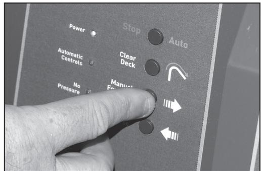
Drücken Sie die Taste **Stop/Auto**. Die Kontrollleuchte „Automatische Steuerung“ ist jetzt eingeschaltet. Das Gerät ist betriebsbereit.
