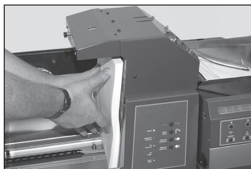
Schieben Sie die Materialstützenplatte während des Ladevorgangs nach oben gegen jeden einzelnen Materialstapel, um diesen zu stützen, während Sie den nächsten Stapel holen.
