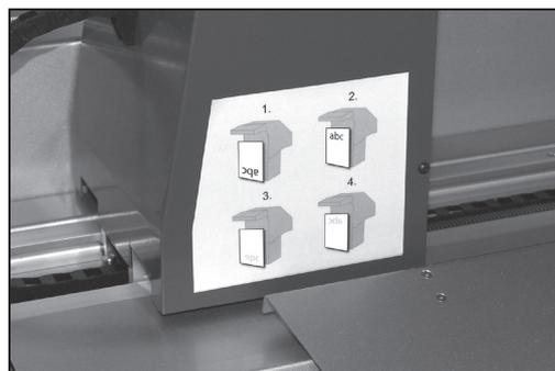
Laden Sie Material bis an die rechte Seite des Zuführungssystems, flach gegen die Zuführungsbänder.
