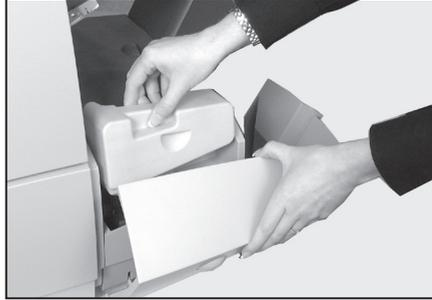
2. Retirez les plateaux à encarts (consultez la page 5-9). Levez le couvercle de plastique du dispositif d'insertion et ouvrez le panneau du bloc de sortie des enveloppes.
