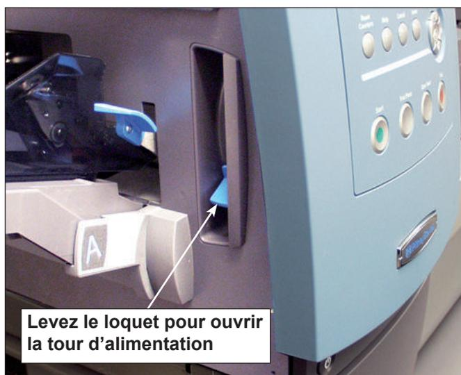
Figure 2.2.1. Loquet d'ouverture de la tour d'alimentation.
