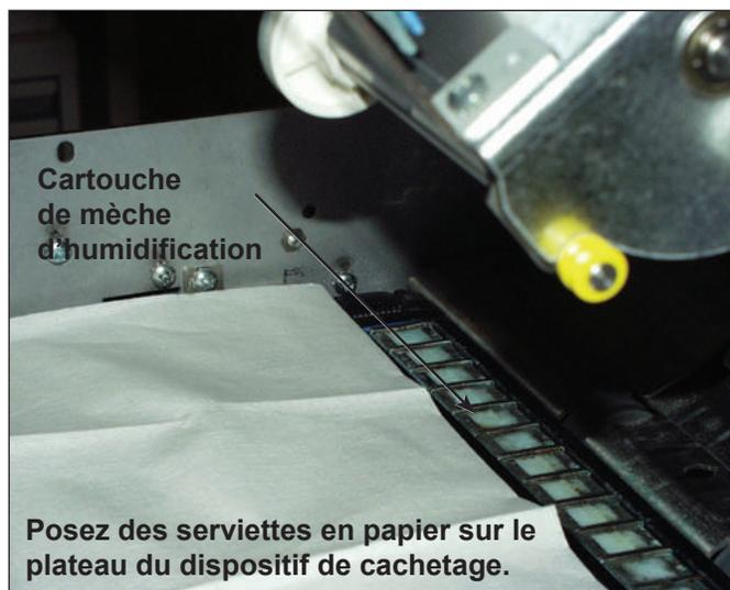
Figure 5.1. Préparation au retrait de la cartouche de la mèche d'humidification
