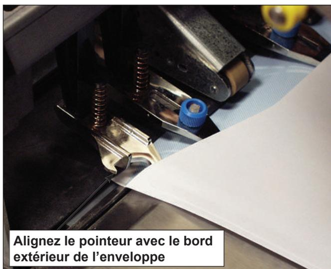
Figure 3.9.3. Alignement du dispositif d'ouverture d'enveloppe
