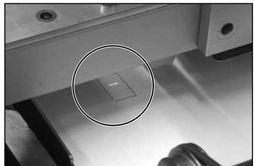
Réglez la position latérale du scanner en le faisant coulisser manuellement jusqu'à ce que le faisceau soit centré sur les marques de lecture.
