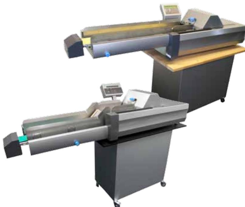
Ce chapitre contient les instructions de configuration, de chargement et d'utilisation du chargeur grande capacité F774/F772 et de l'alimenteur universel F767.
