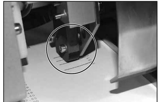
Procédez au réglage latéral du scanner jusqu'à ce que le faisceau soit centré sur les marques de lecture. Desserrez le bouton moleté (représenté), alignez le scanner puis resserrez le bouton.
