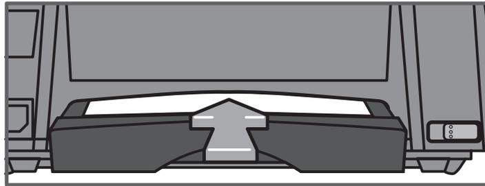
**5** Neuen Tintenauffangbehälter in die Maschine schieben, bis der Schiebehebel hörbar einrastet.
