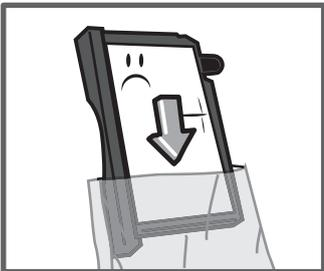
**4** Benutzen Tintenauffangbehälter in die Verpackung schieben und entsorgen.
