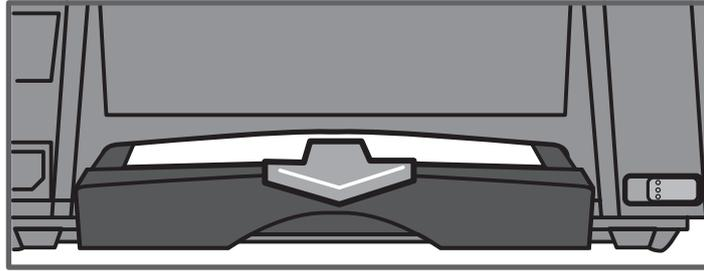
**2** Tintenauffangbehälter aus der Maschine ziehen. Schiebehebel loslassen.
