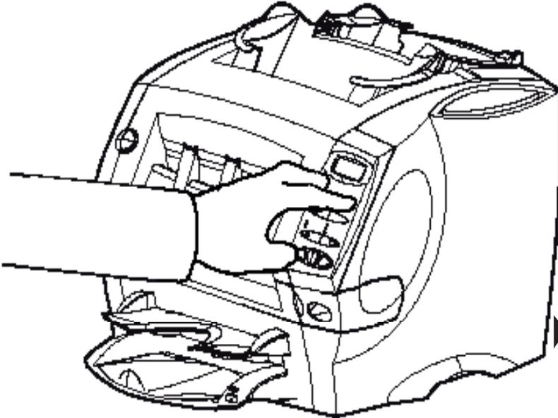
b. Schalten Sie die Maschine mit dem Hauptschalter auf der Rückseite ein, während Sie die **Ja** und **Nein** Taste gleichzeitig gedrückt halten.
