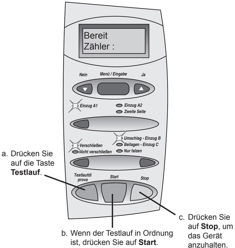
Bei einem **TESTLAUF NICHT VERSCHLOSSEN**. Das ist normal, denn so können Sie den Inhalt des Umschlags kontrollieren.
