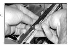
Verwenden Sie die als Zubehör mitgelieferte Plastikpinzette, um alle vier Filze aus dem Behälter mit der Schließflüssigkeit zu entfernen.
