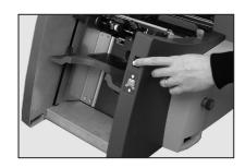
Richten Sie die Seitenführungen mit dem Einstellrad bündig an den Kanten der zugeführten Kuverts aus, und drehen Sie das Rad dann eine Viertelumdrehung zurück. Dadurch wird der benötigte Abstand zwischen den Kuverts und Seitenführungen gewährleistet.
