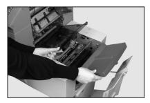
Die in der Abbildung mit Pfeilen gekennzeichneten Teile können entfernt werden, um den Zugriff auf gestautes Material zu ermöglichen.
