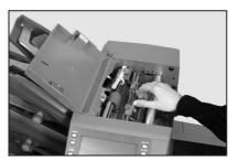
Griffe zusammen, und schwenken Sie die Führung zurück in die Betriebsposition. Lassen Sie die Griffe los, und vergewissern Sie sich, dass die Führung fest eingerastet ist.
