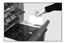
Öffnen Sie die Zugriffsklappe der Kuvertierstation, und heben Sie die Plastikabdeckung des Kuvertierbereichs an.
