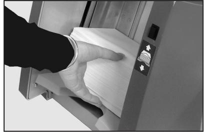
5. Appuyez de nouveau sur le bouton de chargement de l'alimenteur d'enveloppes pour placer la pile d'enveloppes à la position d'alimentation.
