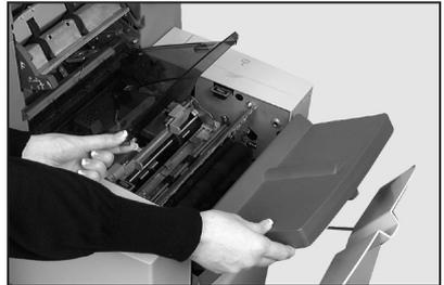
3. Pressez les deux taquets bleus (A) ensemble et levez le taquet bleu (B) pour accéder aux tampons du dispositif de cachetage.
