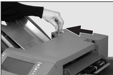
N'oubliez pas de remettre le levier à sa position initiale pour utiliser l'alimenteur en mode automatique.
