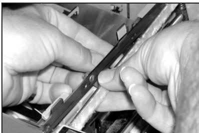
6. À l'aide des pinces en plastique du nécessaire, retirez les quatre tampons du réservoir du dispositif de cachetage. Mettez ces tampons au rebut.
