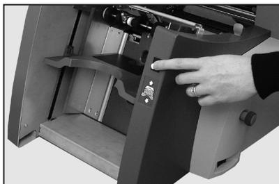
2. Réglez les guides latéraux en fonction de la *largeur* des enveloppes à l'aide de la molette de réglage des guides latéraux, puis tournez la molette d'un quart de tour. Cela éloigne les guides afin qu'ils effleurent les enveloppes.
