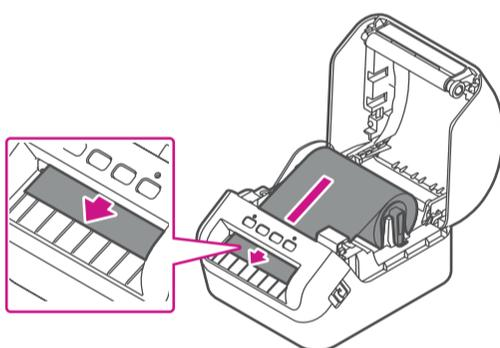
Si vous avez de la difficulté à charger le rouleau d'étiquettes, essayez de l'insérer par le côté, en veillant à ce que l'étiquette passe sous le détecteur.
