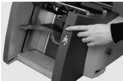
2. Utilisez la molette de réglage des guides latéraux pour ajuster les guides à la *largeur* des enveloppes. Une fois l'ajustement effectué, reculez la molette de réglage d'un quart de tour
