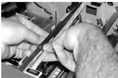
7. À l'aide des pinces en plastique fournies dans la trousse, retirez les quatre feutres du réservoir du dispositif de cachetage. Jetez les feutres usagés.
