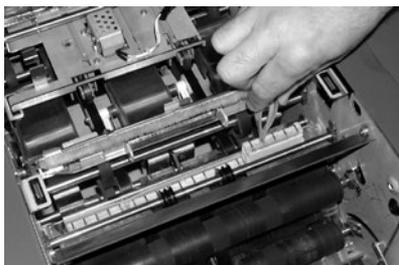
8. Installez les quatre nouveaux feutres dans le réservoir du dispositif de cachetage. Les nouveaux feutres ne s'adaptent que dans un sens. Abaissez complètement les feutres dans le réservoir.
