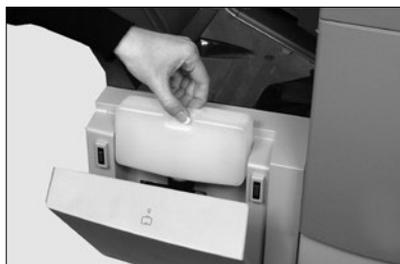
*REMARQUE : si le dispositif de cachetage était entièrement vide, allouez une période suffisante pour que la solution ou l'eau imbibent correctement le mécanisme avant de poursuivre l'opération. Cette période assure un bon cachetage.*
