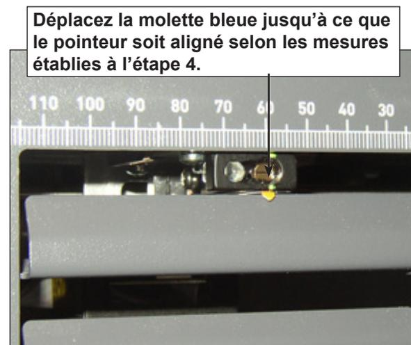
**Figure 8.4 : Utilisez le pointeur pour vérifier la position de la tête de balayage**
