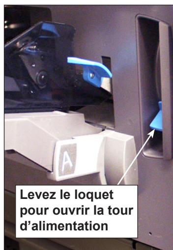
Figure 2.2.1 : Loquet ouvrant la tour d'alimentation
