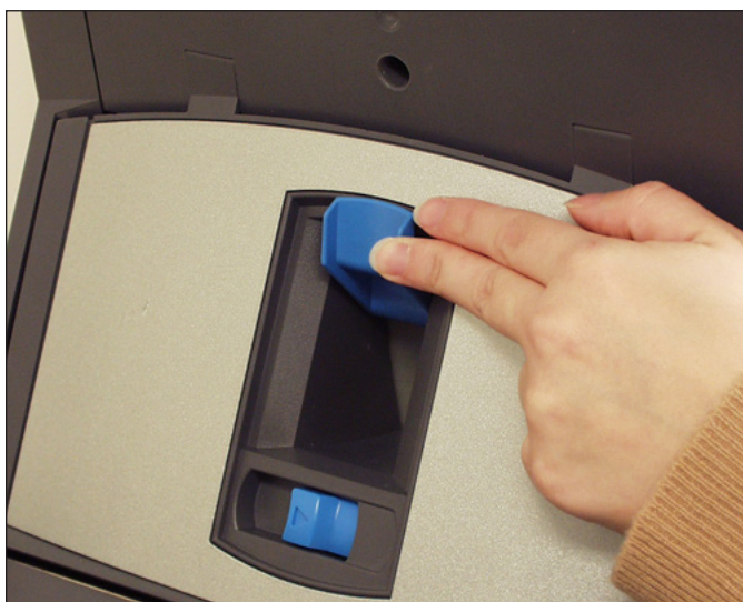
Figure 3.8.1 : Pousser le levier d'écart de séparation
