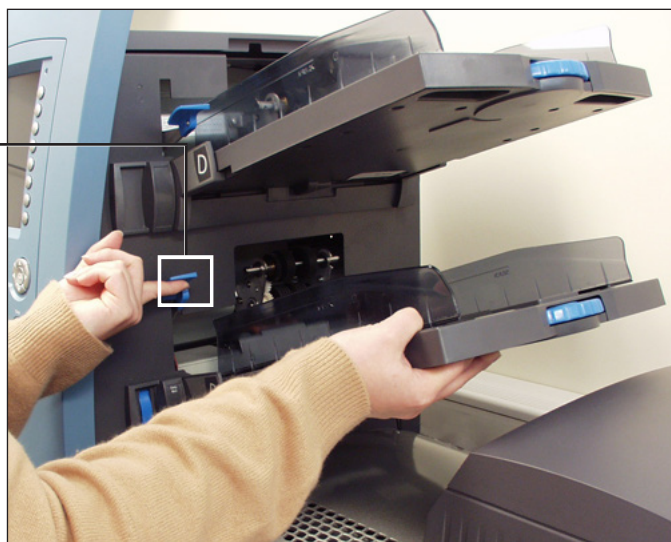
Figure 3.1.1 : Soulevez le séparateur et faites glisser le plateau dans ses supports.
