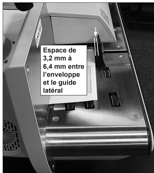
Figure 7.16 : Jeu entre l'enveloppe et le guide latéral
