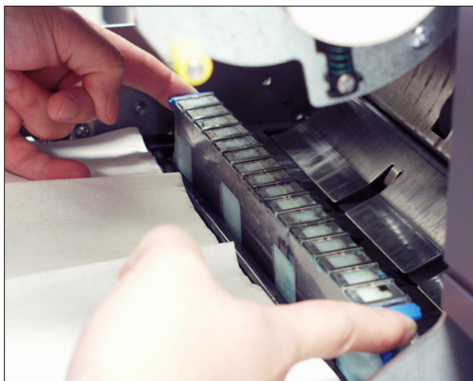
Figure 5.3 : Retrait de la vieille cartouche de mèche
