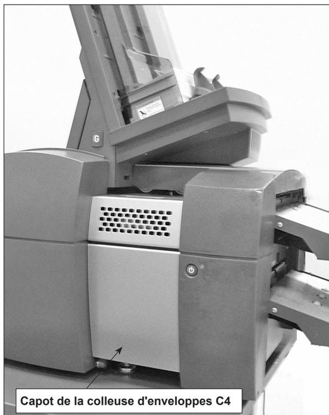
Figure 7.8 : Module Colleuse d'enveloppes C4 (représenté ici avec un CEHC)
