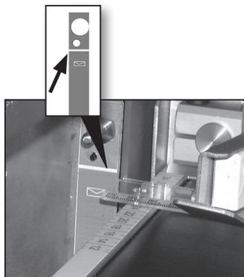
3. Au besoin, desserrez les boutons de réglage de la hauteur (C) de chaque patte alternativement et corrigez la hauteur de l'empileuse.
