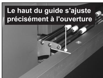
5. Au besoin, desserrez les boutons de réglage de la hauteur (**C**) de chaque patte alternativement et corrigez la hauteur de l'empileuse.
