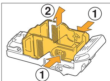
**4** Insérez la partie avant du nouveau boîtier d'agrafes dans la cartouche, puis insérez la partie arrière.
