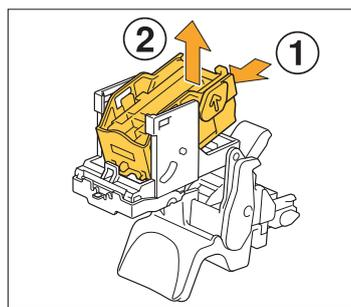
**7** Insérez la partie avant du nouveau boîtier d'agrafes dans la cartouche, puis insérez la partie arrière.
