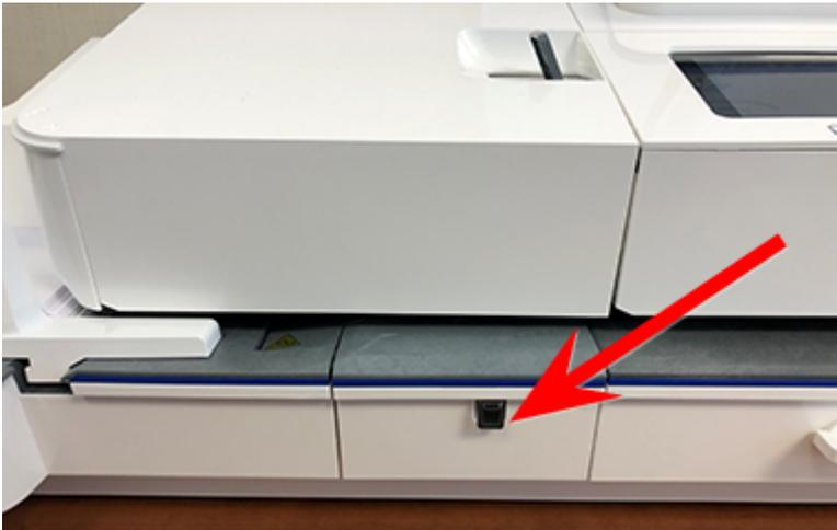
2. Öffnen Sie die Abdeckung der Zuführung, um Zugang zur Schließflüssigkeitsflasche zu erhalten.
