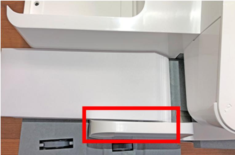
4. Schieben Sie den Stapel in die Zuführung, bis Sie einen Widerstand spüren. Die Abbildung zeigt, wie weit Sie den Stapel in die Zuführung einlegen müssen. Die Seitenführung ist weggezogen, um die Kante der Umschläge zu zeigen.
