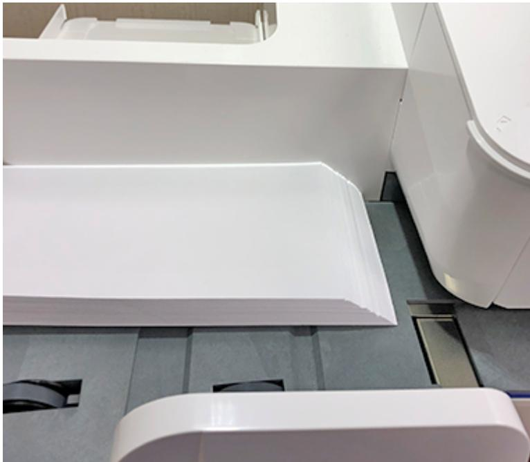
3. Lassen Sie zwischen dem Stapel und der Seitenführung etwa 3 mm Abstand, damit die Umschläge nicht gegen die Führung gezogen werden.
