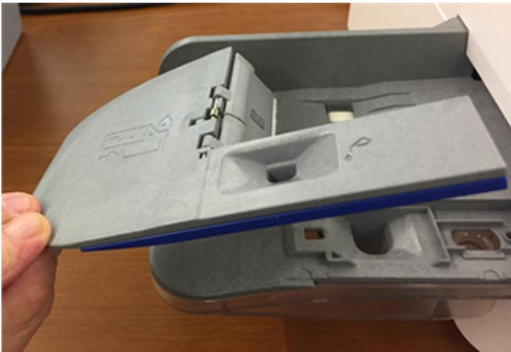
3. Drehen Sie die Einheit um und schieben Sie die Anfeuchtbürste aus der Halterung.
