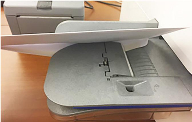
6. Legen Sie den Umschlag in das System ein. Das System verschließt das Kuvert.
