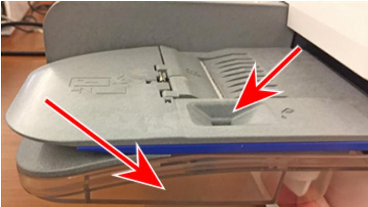
2. Schieben Sie die Kuvertklappe unter die Kante des Zufuhrfachs, wenn Sie ein Kuvert einlegen. Andernfalls kann die Kuvertklappe nicht befeuchtet werden.
