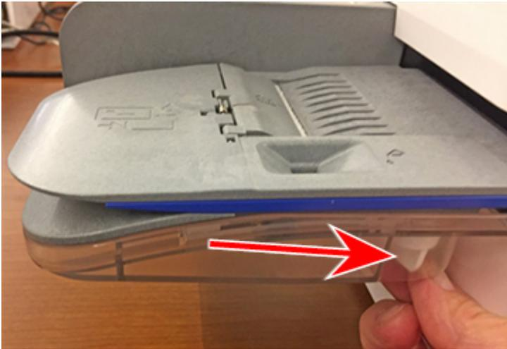
2. Heben Sie die Anfeuchtbürsten-Einheit von der Oberseite der Befeuchterauflage ab.
