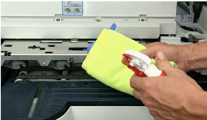
5. Reinigen Sie die (a) Druckereinzugswalze und das (b) W-O-W-Fach und das (c) Druckerfach.
