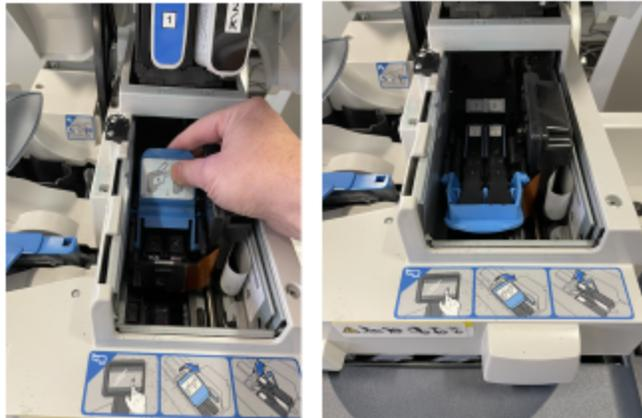
11. Stellen Sie den blauen Druckkopfhebel vertikal nach oben, und heben Sie den Druckkopf nach oben heraus.
