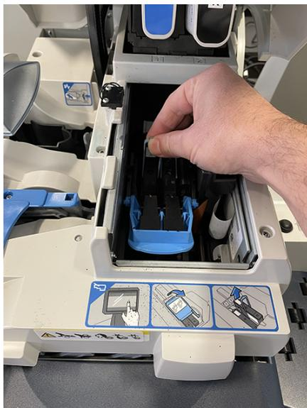
12. Setzen Sie den Druckkopf wieder ein. Der Druckkopf-Kontakt muss in Richtung Vorderseite des Frankiersystems zeigen.
