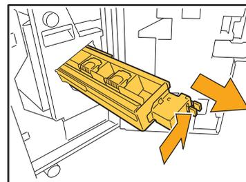
**3** Halten Sie die Laschen links und rechts an der Kassette und ziehen Sie sie nach oben links.
